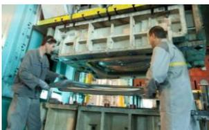
Emboutissage : Des plaques métalliques sont frappées entre deux « matrices » sur d'énormes presses (ex éléments de carrosserie d'une auto).
