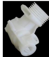
Carter-cylindre de moteur pour modèle réduit réalisé par stéréo lithographie
